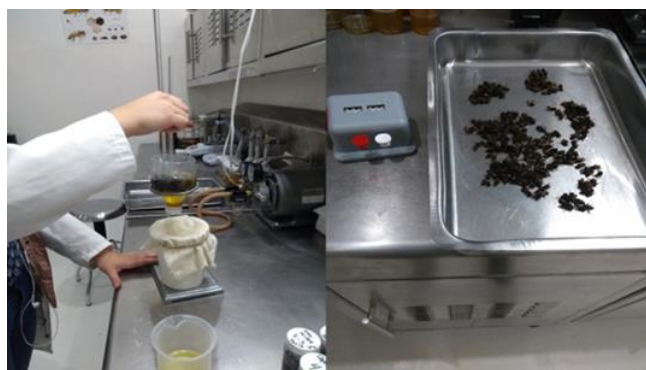
Figura 6. Diagnóstico de varroasis, por medio del método de lavado (De Jong).
